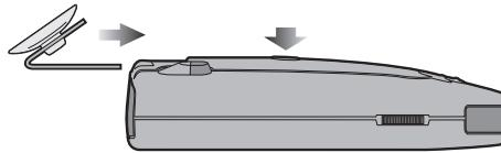
Вы можете оставлять кронштейн на лобовом стекле, отсоединяя прибор с помощью кнопки быстрого монтажа.
